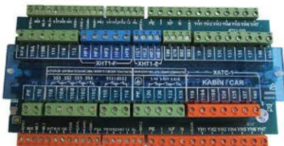
شکل 11. برد 12-13 KBK نصب شده در پایین تابلو فرمان
