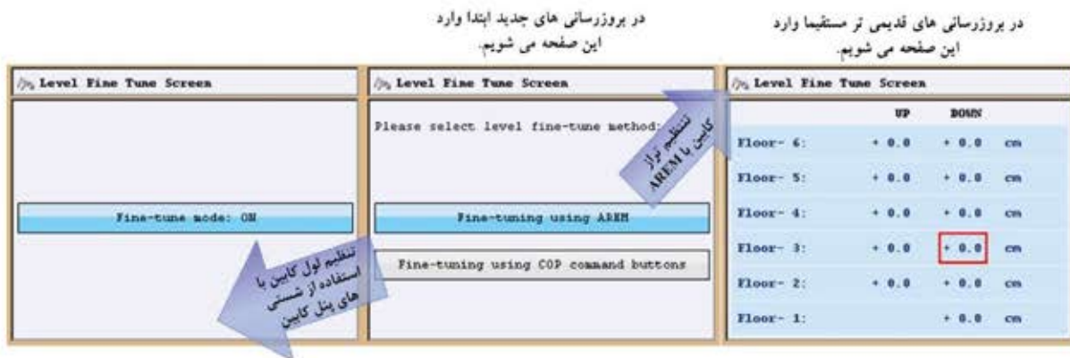
شکل 66. صفحه تنظیمات دقیق طبقات
