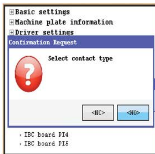
شکل 57. انتخاب نوع کنتاکت (NO, NC)
