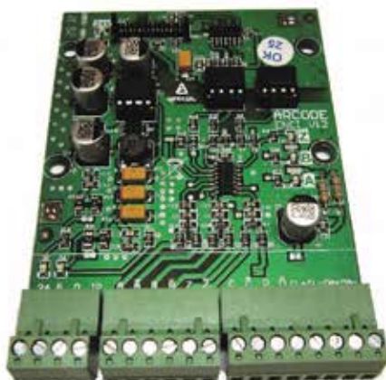
شکل 7. د. برد انکودر ENCI مربوط به موتورهای گیربکسی
